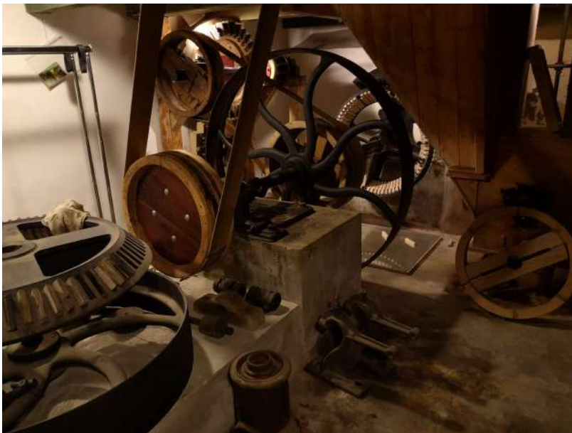
Abbildung 1.1: Maschinerie zum unterschlächtigen Wasserrad im Keller (Quelle: Anne Krohn, AG Ideenkonzept MGK).
